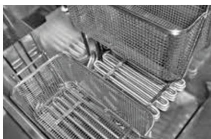
Résistances électriques immergées dans la cuve.
